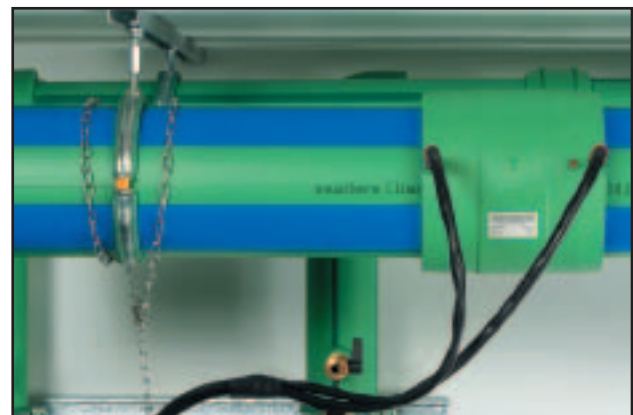
Buisdiameter invoeren in het lasapparaat. Lasproces starten. Afkoeltijd hanteren. Klaar!
