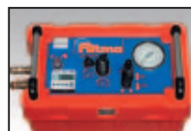
Het functioneren van de lasmachine controleren en deze vervolgens opwarmen.
