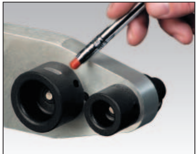
Temperatuurcontrole met een oppervlakte handthermometer
