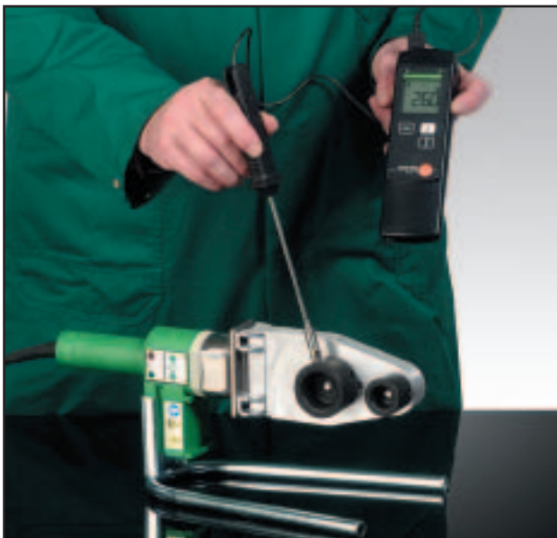
Temperatuurcontrole met een oppervlakte handthermometer
