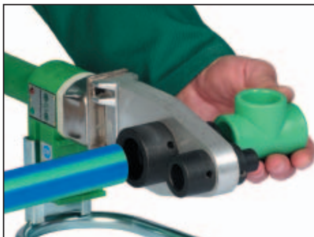
Opwarmen van de te lassen buis en fitting
